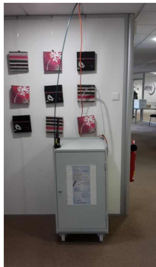
Figure 3 : Dispositif de prélèvements en air intérieur
